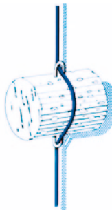
Montage du bouchon pour déterminer la profondeur de l'eau
